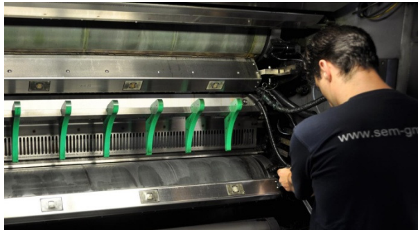
S.E.M.-Mitarbeiter bei Wartungsarbeiten an der Colorman.
